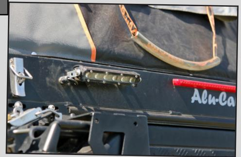
Pour y voir clair lors des marches arrière nocturnes, deux petites barres à leds branchées sur le feu de recul prennent place à l'arrière.
