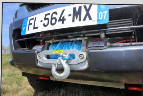
L'installation du treuil Come-up DS 9.5 à l'avant a nécessité l'ajout d'une platine N4 Offroad et le découpage de la partie basse du pare-chocs.
