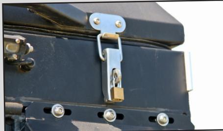
Afin qu'un plaisantin n'ouvre pas le toit relevable, il est possible de le verrouiller en position fermée à l'aide d'un simple cadenas.
