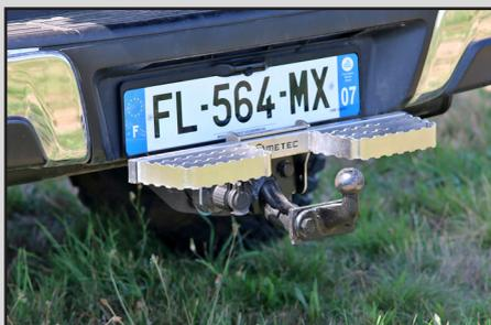
Afin de faciliter l'accès à la benne, ce marchepied Metec a été boulonné sur l'attelage du pick-up.
