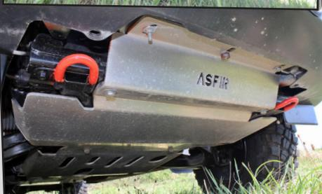
Pour ne pas alourdir excessivement son partenaire mécanique, le boss de Modul Auto a opté pour un blindage intégral Asfir en aluminium de 6 mm.
