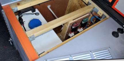
Dans le meuble droit, se cachent une batterie auxiliaire au gel ainsi qu'un chauffage autonome Yikar.
