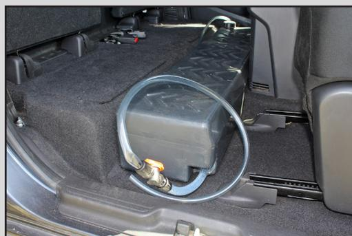
Logée derrière les sièges avant, ce D-max embarque une réserve d'eau FrontRunner de 40 litres. À signaler qu'une pompe Fiamma est en stand-by dans le compartiment situé sous le strapontin droit pour utiliser une douchette. Sinon, il est possible de se laver les mains rapidement en ouvrant le robinet. L'eau coule alors par gravité.
