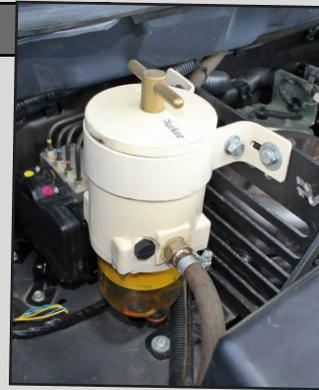
Pour purifier le gasoil avant son arrivée au moteur, un préfiltre décanter prend place dans le compartiment moteur sur un support N4 Offroad.
