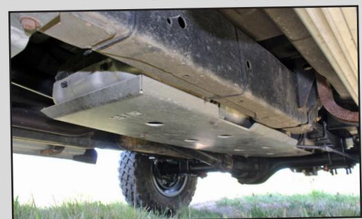
À l'image du reste de la mécanique, le réservoir à gasoil de ce pick-up se cache désormais derrière une protection Asfir en aluminium.
