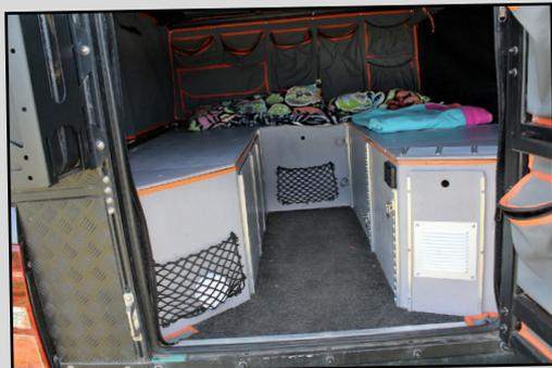
Pour qu'il résiste aux vibrations de la piste, l'aménagement de ce pick-up a été réalisé en contreplaqué collé/vissé.
