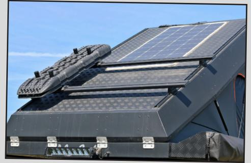
Afin de pouvoir emmener un jeu de plaques de désensablage ou une roue de secours supplémentaire, le hard-top Alucab se pare d'un jeu de barres de toit.
