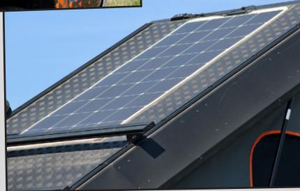
Afin de ne pas craindre une quelconque décharge intempesive de la batterie auxiliaire lors de bivouacs prolongés, un panneau solaire souple de 120 watts prend place sur le toit du hard-top sud-africain.
