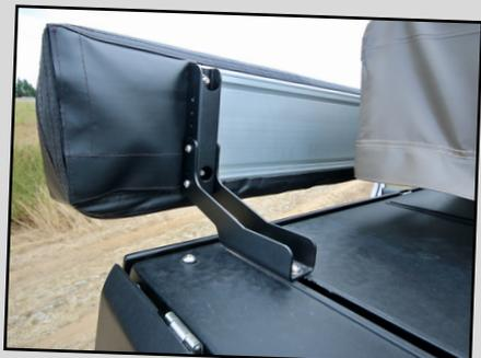
Parmi les avantages du hard-top Rockalu Gen 2, son toit intègre des rails d'arrimage. Résultat, il suffit d'y ajouter des pattes de fixations comme celle-ci pour y fixer un auvent. Nul besoin d'ajouter des barres de toit !
