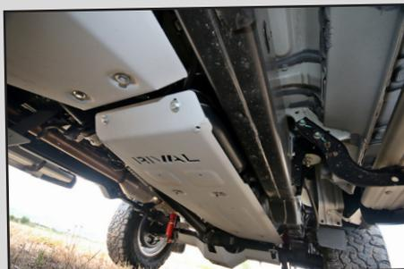
À l'instar de la mécanique, le réservoir de ce Revo se cache derrière un ski en aluminium Rival 4x4.
