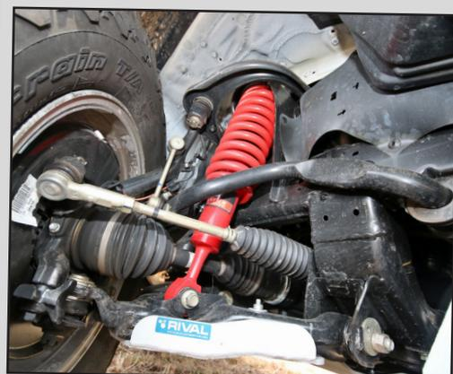
Nouvelle suspension made in Australie ! Désormais, ce Hilux repose à l'avant sur des combinés filetés Pedders.
