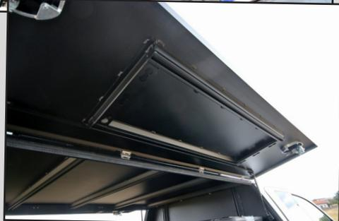
En sus des rails d'arrimage extérieurs, les ouvrants et le toit du hard-top Rockalu disposent de rails intérieurs.
