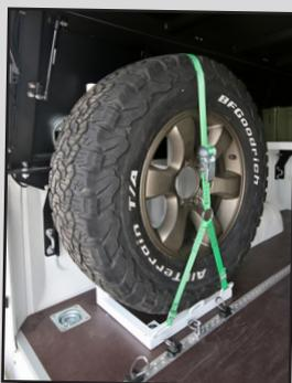
Autre création made in Modul Auto, ce rack de roue de secours est boulonné au plancher et sur la face intérieure de l'aile arrière.
