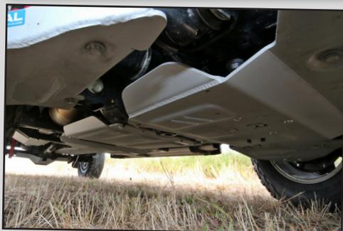
Un vrai fond plat en aluminium ! En plus du ski avant, ce Toyota se voit équipé d'un blindage intégral qui court jusqu'en sortie de boîte de transfert.
