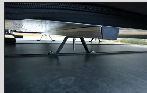
À l'instar de l'auvent, la tente de toit FrontRunner est fixée au toit du hard-top Rockalu via des pattes reprises sur les rails d'arrimage intégrés.
