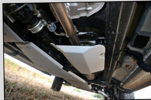
Sur ce Revo, le filtre à particules et le réservoir d'Adblue ne craignent pas les chocs grâce à un ski Rival 4x4.
