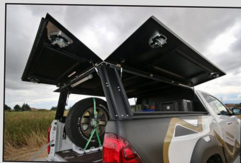
Comparé à un modèle en fibre, de par sa conception en aluminium, le Rockalu Gen2 bénéficie d'ouvrants XXL pour un accès total à la benne.
