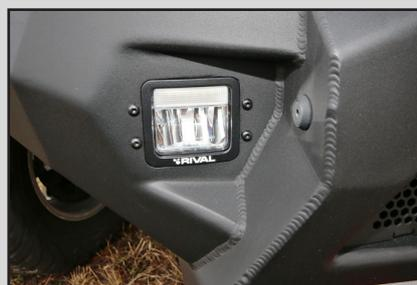
De série, le pare-chocs Rival 4x4 arrive avec un jeu d'antibrouillards à leds.
