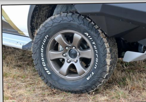
Niveau pneumatiques, petit changement à signaler. À présent, ce Toyota à benne est chaussé de BFGoodrich All Terrain en 265 / 70 R17.
