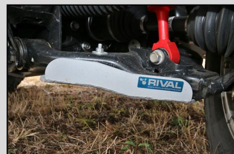
Autre protection en aluminium installée sur le Revo Worker, ces blindages de triangles inférieurs de suspension.
