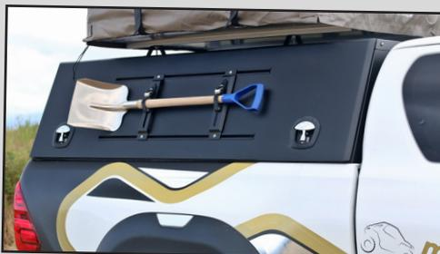
Particularité du hard-top Rockalu Gen 2, ses ouvrants sont pré-équipés de rails d'arrimage extérieurs qui permettent d'y fixer facilement des accessoires. Comme ici, cette pelle de désensablage.
