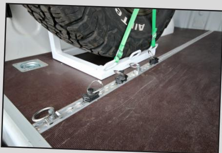
Afin de faciliter l'arrimage du chargement de la benne, le plancher imaginé par le boss de Modul Auto intègre des rails aéro.
