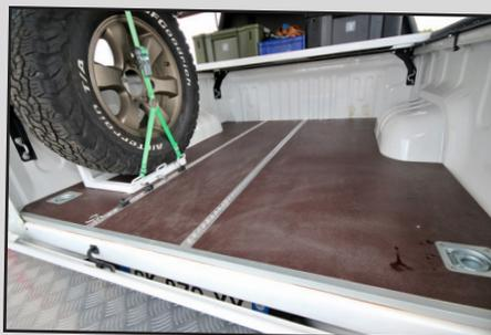
Plancher made in Annonay ! Au lieu d'un classique bedliner, Christophe a installé un plancher en contreplaqué de sa création sur le plancher de la benne de ce Toyota.
