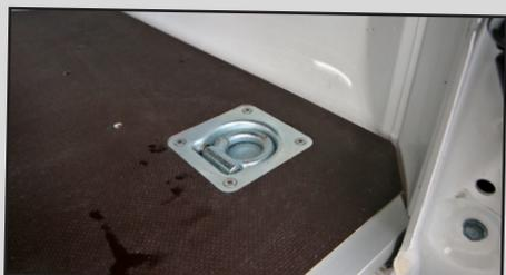
Sur le Worker, le plancher en bois de la benne disposait de 2 gros anneaux d'arrimage. Mais, vu que Christophe les fabrique sur mesure, il peut en ajouter d'autres à la convenance de ses clients.
