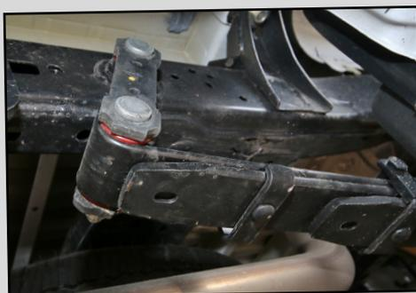
En association avec les amortisseurs Pedders, cet Hilux repose sur des lames arrière + 300 kg de la marque australienne.
