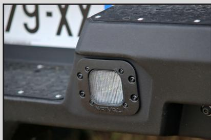
À l'instar du bumper avant, le pare-chocs arrière Rival 4x4 intègre de série un jeu d'antibrouillards à leds.
