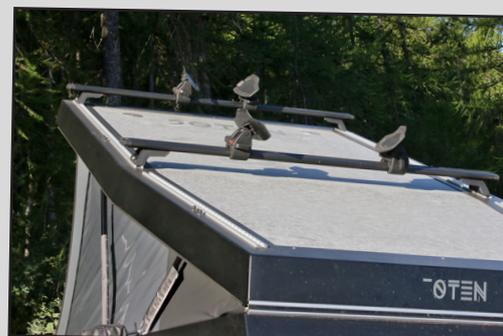
Pouvant supporter jusqu'à 50 kg de charge en dynamique, le canopy made in ModulAuto est équipé de série d'un jeu de rails aéro destinés à recevoir des barres de toit.
