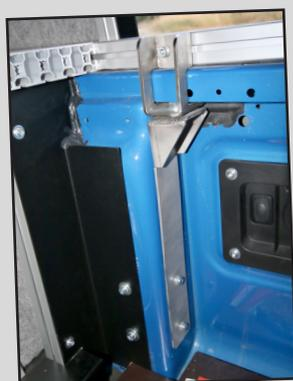
Côté fixation, le Truckbed Camper est solidaire de la carrosserie via ces pattes se reprenant sur les points d'ancrage de la benne
