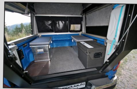
À Valloire, l'aménagement de la benne du VW Amarok était plutôt « basique » avec deux cantines en aluminium transformées en banquette et un bac isotherme. Le tout solidement fixé sur un plancher en bois. Mais ce n'est qu'un exemple ! Chacun peut imaginer un agencement correspondant le mieux à ses besoins.
