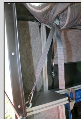
Ne cherchez pas les loquets de verrouillage à l'extérieur. Le toit est solidement maintenu en position fermé via deux sangles comme celle-ci.
