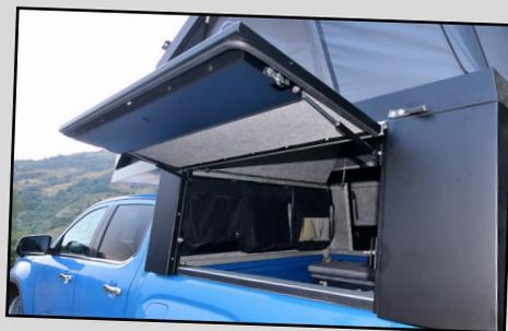
Autre singularité de ce hard-top en aluminium, il dispose de deux ouvrants latéraux XXL.
