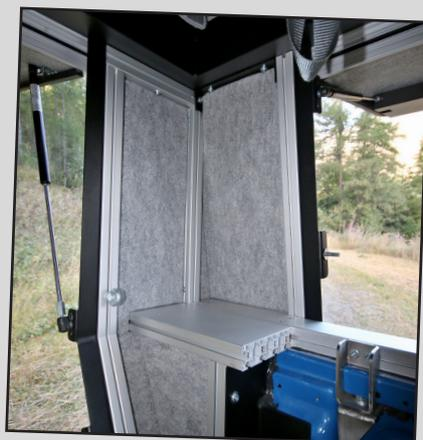
Histoire qu'il soit facile d'y arrimer ou sangler des accessoires, plusieurs profilés rainurés sont intégrés à la structure du canopy made in ModulAuto. Ainsi, il est facile d'ajouter des anneaux d'arrimage.
