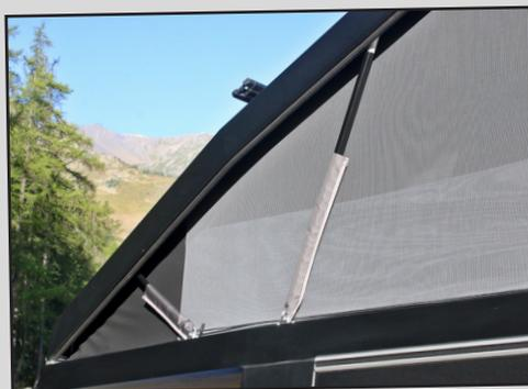
Grâce à ces deux vérins, l'ouverture et la fermeture du toit relevable se révèlent ultra facile.
