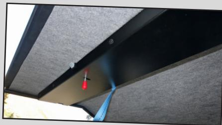
Que ce soient les parois, les ouvrants ou le toit, le canopy imaginé par Christophe bénéficie de série d'une isolation thermique assurée par une moquette de 6 mm. En option, il est possible de la renforcer avec de l'Armaflex en 19 mm d'épaisseur.
