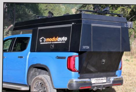
Autre avantage de ce canopy, son poids à vide. Comptez environ 230 kg pour le modèle double cabine et environ 260 kg pour le modèle Xtra Cab.
