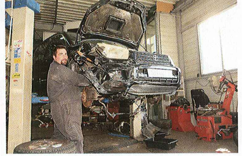
Les véhicules sont expertisés, référencés puis entièrement démontés afin de récupérer toutes les pièces en bon état.
